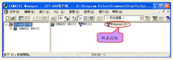
(6) 在出现的 Net Pro 环境中, 先选中 CPU 模块, 再右键单击图示区域, 在出现的列表中选择"插入新链接..."。
