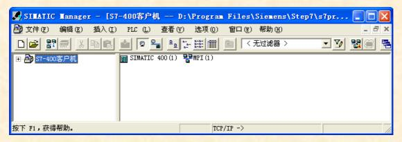
(2)组态 S7-400 硬件, 依次插入导轨, 电源模块和 CPU 模块。在插入 CPU 模块时, 会弹出"属性-PROFIBUS"窗口, 点击"取消"。
