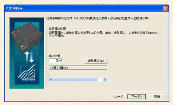
(4)指定 CP243-1 模块的 IP 地址,子网掩膜和网关地址。如网络是B00TP 服务器,可以选定由服务器自动指定 IP 地址。选定模块的连接类型为"自动检测通讯"。点击"下一步"。
