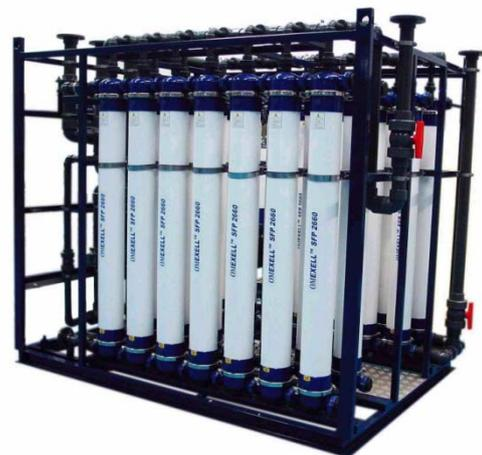
进水水质变化,浊度小于 50 的情况下均可使用,且产水水质较好,产水 SDI 值小于 3。超滤的采用可以更有效地保护反渗透装置,使反渗透膜免受污染,通常情况下使用寿命可从 3 年延长至 5 年,甚至更长时间;同时可提高反渗透膜的设计通水量,即在产水量不变的前提下可减少膜的使用数量,从而减少反渗透装置的设备投资。
