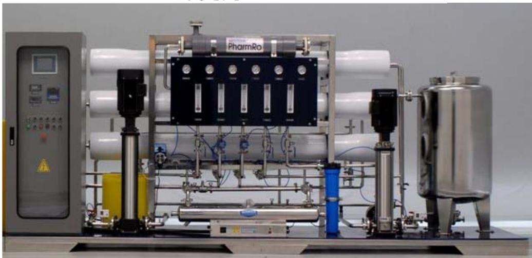
预处理系统的产水进入反渗透膜组,在压力作用下,大部分水分子和微量其它离子透过反渗透膜,经收集后成为产品水,通过产水管道进入后序设备;水中的大部分盐分、胶体和有机物等不能透过反渗透膜,残留在少量浓水中,由浓水管道排出。
